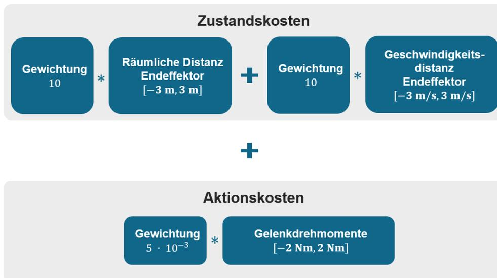
**Abbildung 14:** Kostenfunktion für den Anwendungsfall A2 (autonomer Montageprozess)
