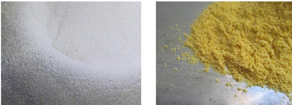
**Abbildung 34:** Die geförderten Produkte. Links S-PVC, ein feines Pulver mit einer Schüttdichte von 0,56kg/l und guten Fördereigenschaften. Rechts Senfmehl mit einer Schüttdichte von 0,39kg/l und bedingt durch die Klebrigkeit, schlechteren Fördereigenschaften.
